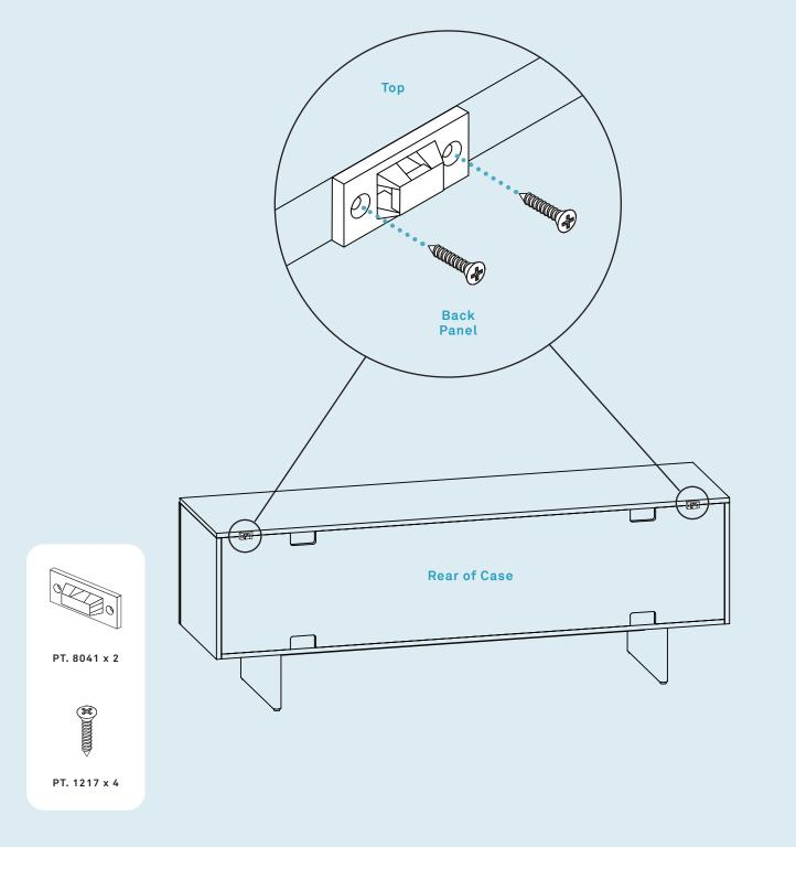
ATTACH ANTI-TIP BRACKET TO THE WALL.
